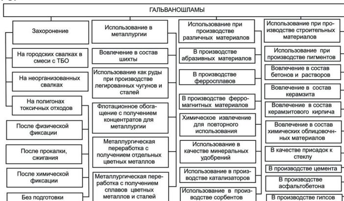
Рис. 1. Классификация осадков сточных вод гальванических производств по способам переработки, утилизации и обезвреживания
