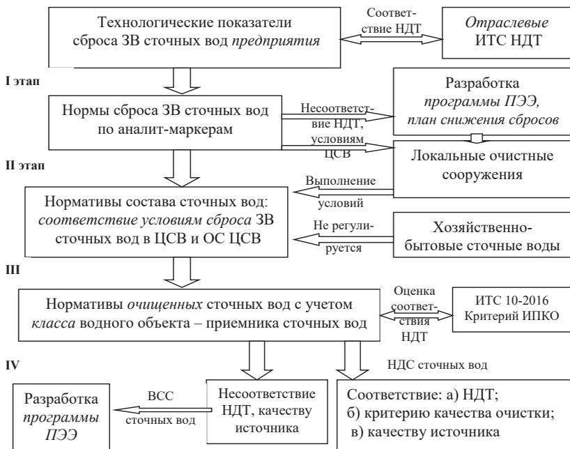
Рис. 1. Схема поэтапного нормирования сброса ЗВ сточных вод в централизованную систему водоотведения и на очистные сооружения с последующим поступлением в водный объект
