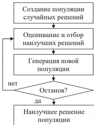
Рис.2. Общая схема работы популяционного алгоритма
